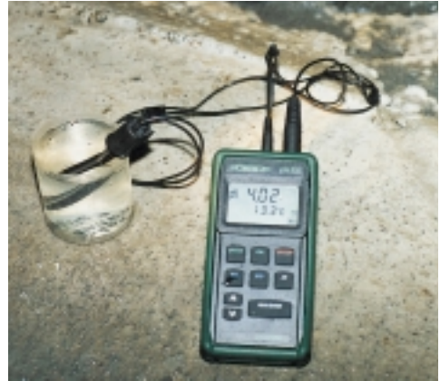
Abb. 3: pH-Messung im Sicherheitsstollen 10 m südlich des Querschlags 47 (ca. km 6,440 vom Südportal).
