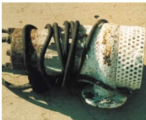
Abb. 8: Pumpe nach zwölfmonatigem Einsatz im Pumpenschacht. Durch die starken Versinterungen steigt der Unterhaltsaufwand.
