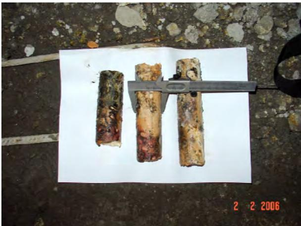
**Bild 3: Depotsteine Typ A (Produkt M.C. Wegmüller, Haichem PS-523)**
