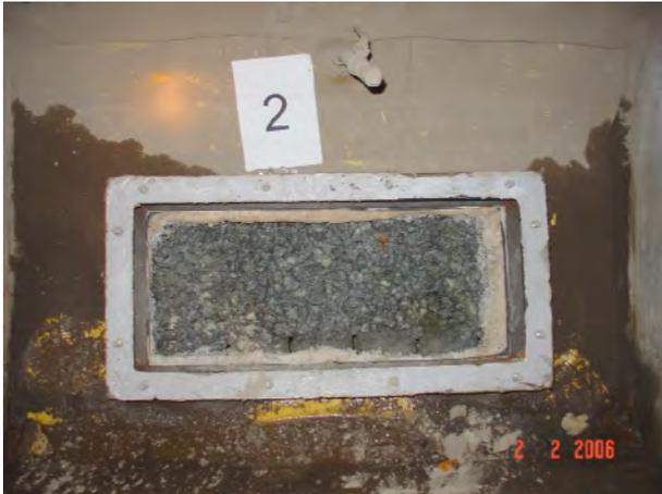
**Bild 1: Oberfläche der Sickerpackung**
