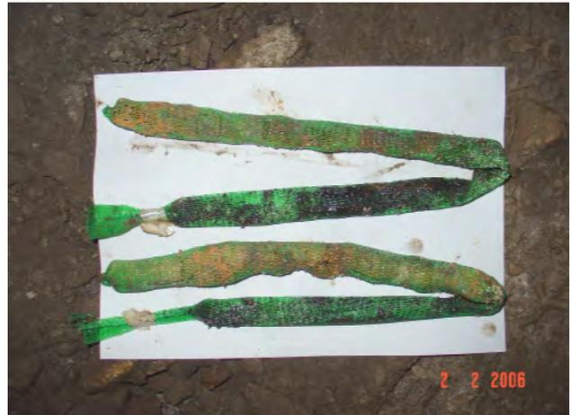
**Bild 4: Netzsäcke von Depotsteinen Typ B
